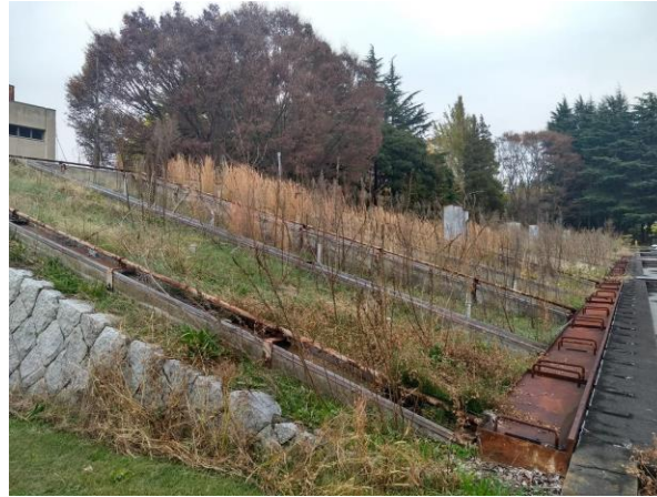
Ilustración 22 Modelo para medir la erosión hídrica.
