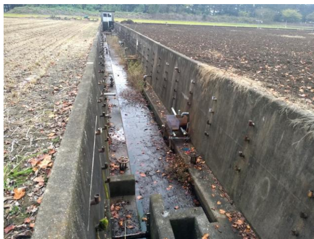
Ilustración 21 Lisímetro con drenaje.
